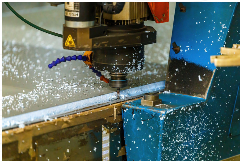
Wycinanie paneli CNC - dowolny kształt
